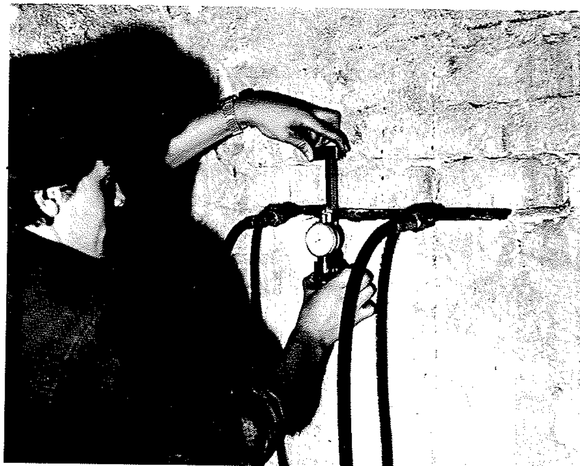
FIG. 22 - Misura delle deformazioni mediante estensimetro rimovibile.
