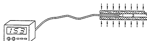
Estrazione del campione e prova dello stesso nella cella biassiale
