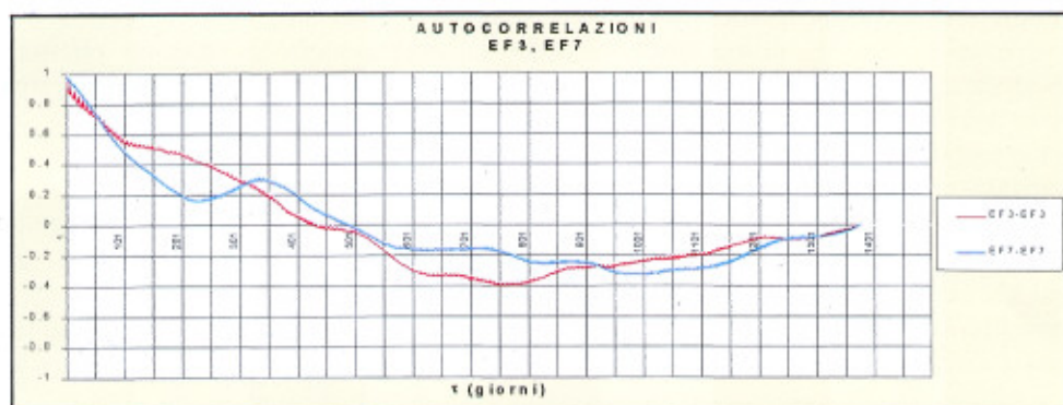
Fig. 11 - Autocorrelazioni degli estensimetri a filo EF3, EF7
