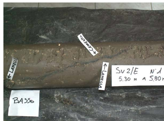
Figura 14. Evidenze della presenza di lame di miscela cementizia nei campioni di terreno estratti durante il corso dei sondaggi post intervento.
